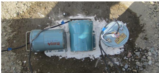
Рис. 4. Расположение сейсмометров ОСП-3 в измерительных точках
